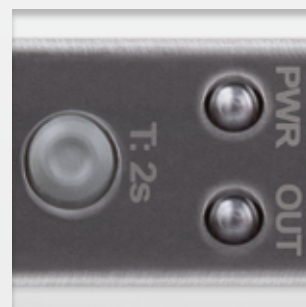
O-34 – Touche d'apprentissage multifonction et LED d'état
